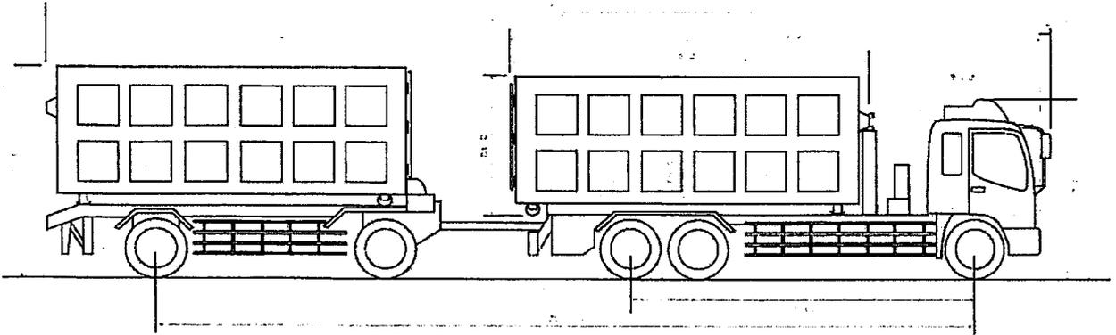
フルトレーラーコンテナ車では、装着するコンテナは、蓋が確実に閉まるものを用いる。
