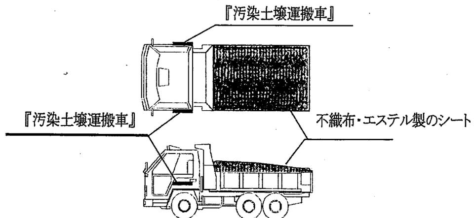
図 3-1 運搬車両の養生 (ダンプ車による運搬の場合)
