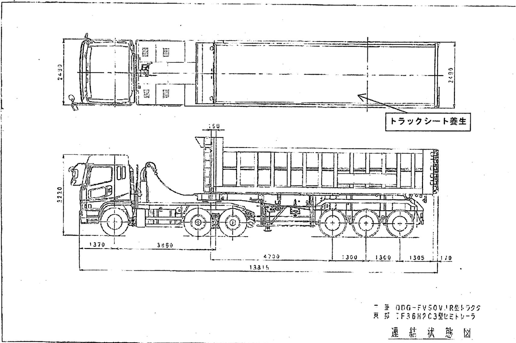
図 3-3 トラクタ+セミトレーラー (運搬車両) の構造図
