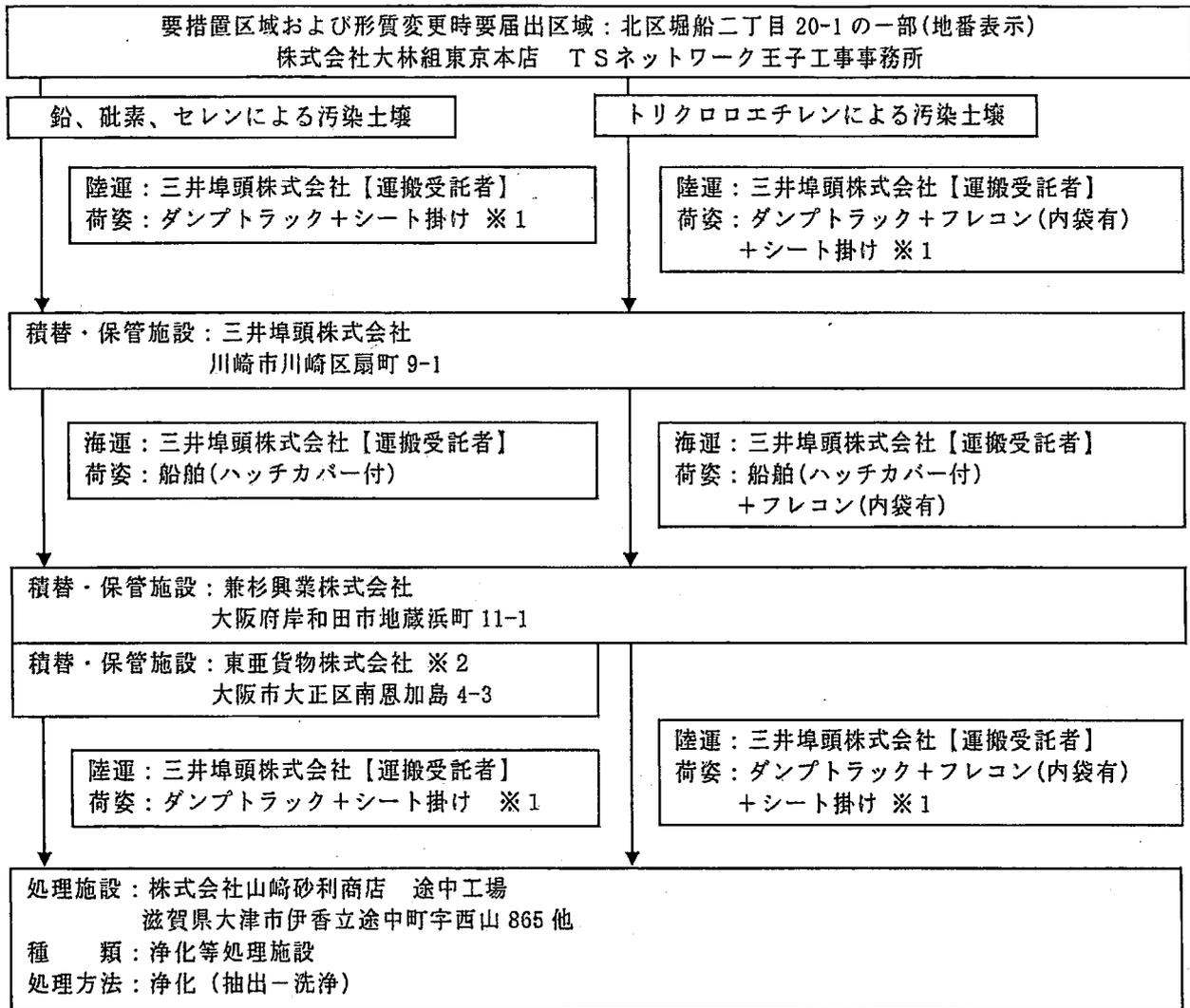
※1：陸上運搬に用いる車両は、ダンプトラックではなくセミトレーラ、フルトレーラコンテナ又はアームロール車とする場合もあります(4. 車両・船舶リスト参照)。荷台に蓋付きコンテナを用いる場合は、シート掛けは行いません。
