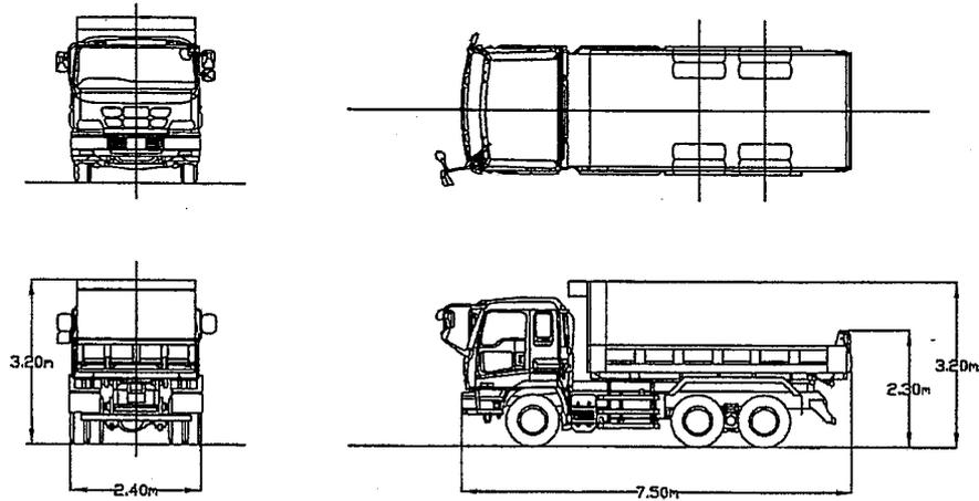
車 輛 構 造 図 『代表写真』 10tダンプ車
