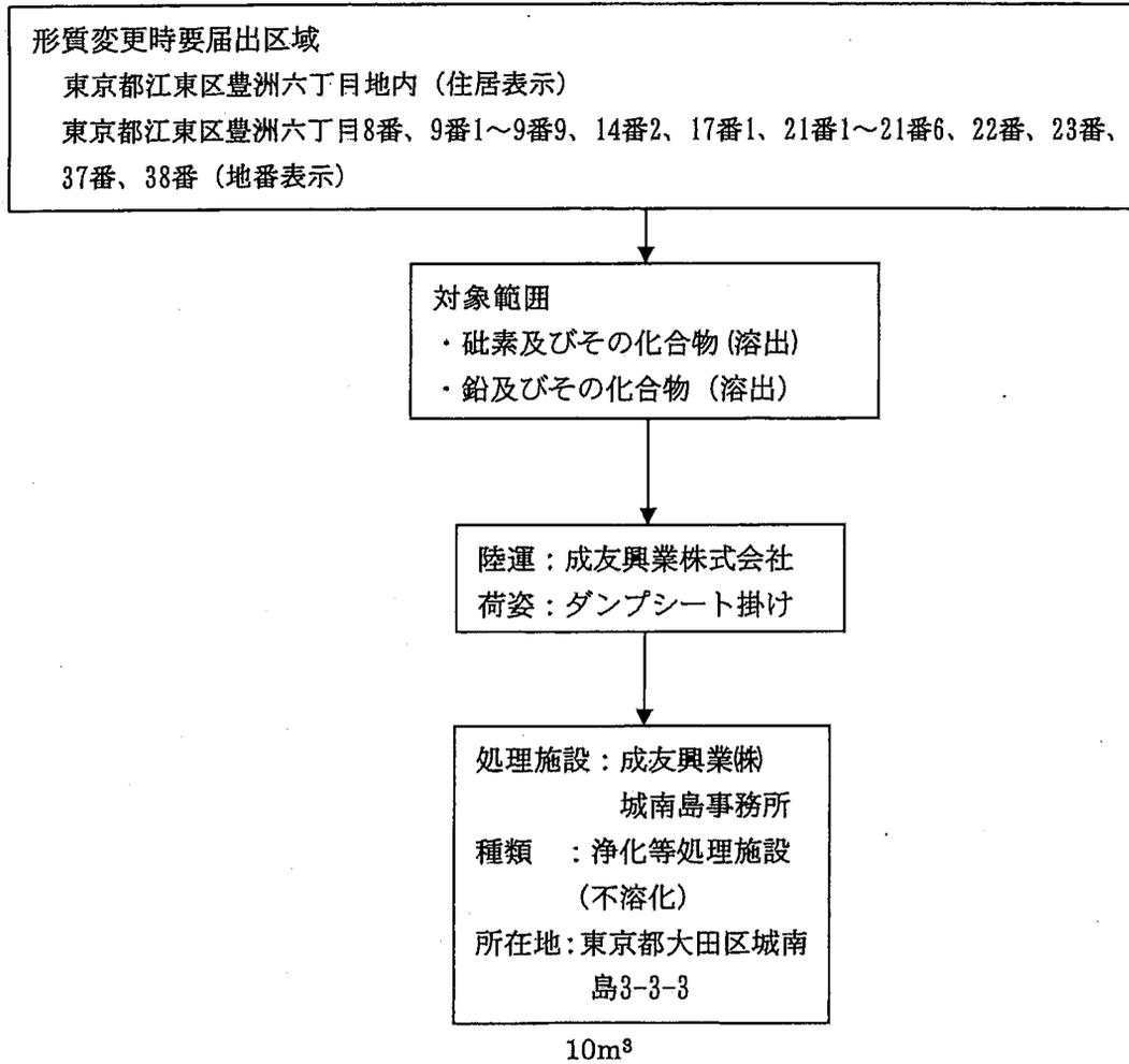
図 3-1 汚染土壌運搬フロー図
